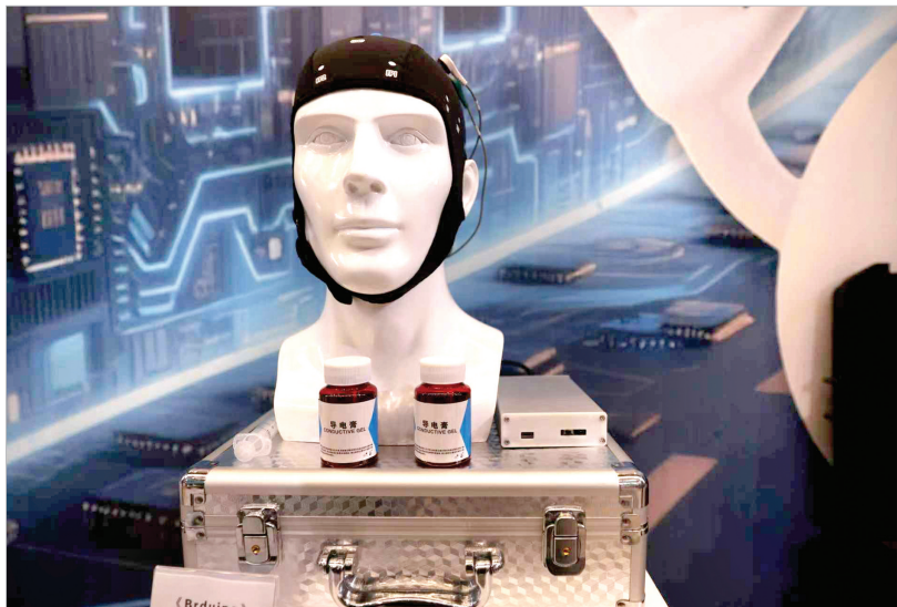
公司的Brduino 脑机接口二次开发平台搭载高精度脑电放大芯片,能精准捕捉微伏级电生理信号。 王国磊摄
