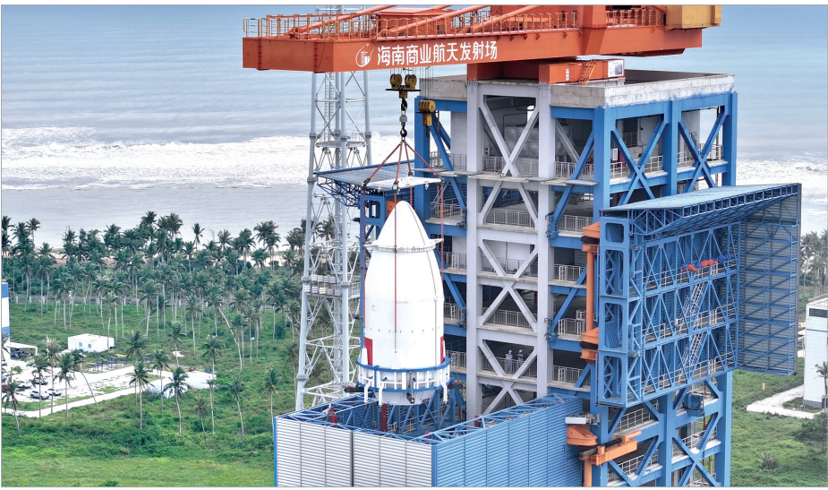
这是11月11日拍摄的长八甲遥五火箭整流罩吊装作业现场(无人机照片)。11月11日,长征八号甲遥五运载火箭在海南商业航天发射场成功实施转运,计划择期发射。长征八号甲运载火箭由中国航天科技集团有限公司一院抓总研制,作为长征八号运载火箭的“升级版”,该型火箭借助模块化组合与新材料应用,大幅提升了运载能力。 新华社记者陈凯姿摄
